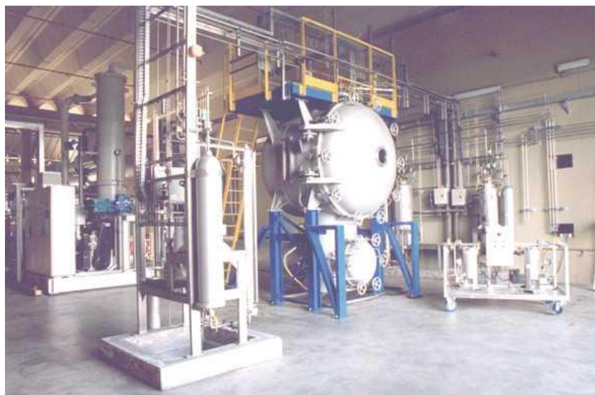
Banco de Testes com Simulação de Altitude para Propulsores de Satélites
